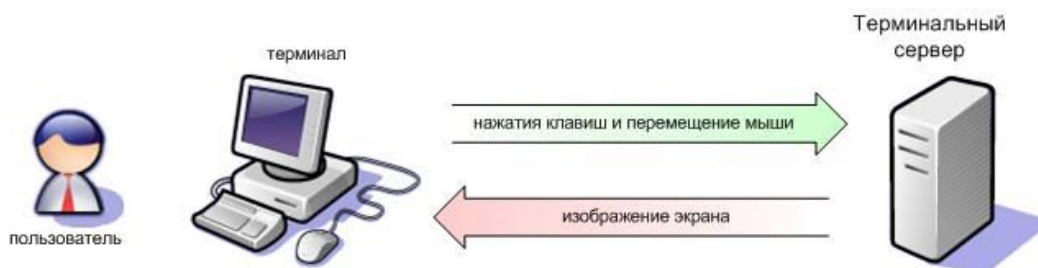
Рисунок 5.8 – Условная схема работы подсистемы терминального обмена
